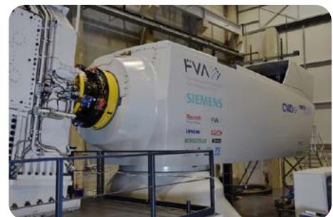
Der Aachener Prüfstand mit der Forschungsgondel der Forschungsvereinigung Antriebstechnik e.V. auf der rechten Seite und dem PTB-Drehmomentsensor zwischen den beiden gelben Flanschen. (Quelle: *)
