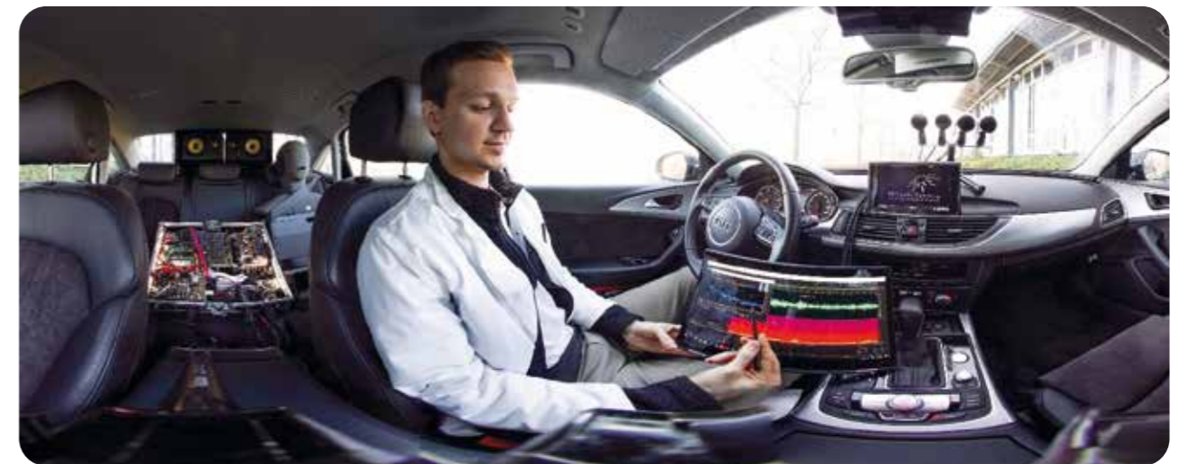
Stefan Ciba, wissenschaftlicher Mitarbeiter im Projekt VerSpiFah, bei akustischen Versuchen zur Verbesserung der Sprachverständlichkeit im Innenraum eines Forschungsfahrzeugs
