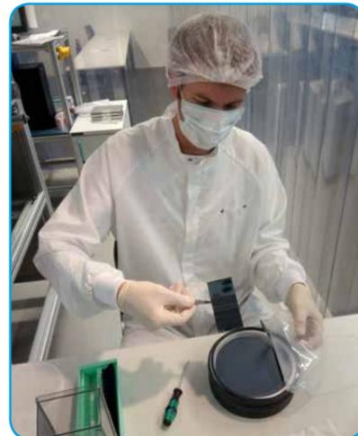
Herstellung der Röntgenspiegel in der Beschichtungsanlage (Bild links) und im Reinraumlabor der TH Aschaffenburg (Bild oben)
