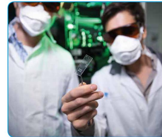
Doktorand Gian-Luca Roth (re) und Bachelorand Konstantin Fliess (li) zeigen ein von der AG alp entwickeltes und realisiertes polymeroptisches Lab-on-a-Chip mit Mikrofluidiken und integrierten optischen Sensorelementen
