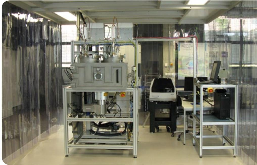
Blick in den Reinraum (Reinraumklasse 100). In den Filtern werden Partikel, die größer als  $0,3 \mu\text{m}$  sind, zu 99,9995% ausgefiltert. Zu erkennen ist in der Mitte der Sputter und hinten rechts das Profilometer (Schichtdickenmessgerät).
