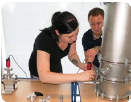
Studierende, die während der Vorlesung „Vakuumtechnik“ an den Versuchsaufbauten praktische Experimente zur Leitwertbestimmung durchführen.
